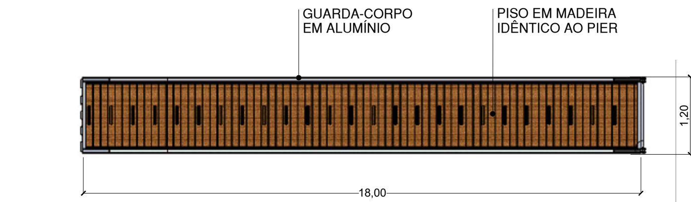
PLANTA TÍPICA DA PASSARELA S/ESCALA
