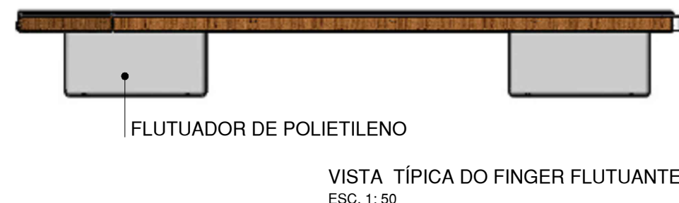
VISTA TÍPICA DO FINGER FLUTUANTE ESC. 1: 50
