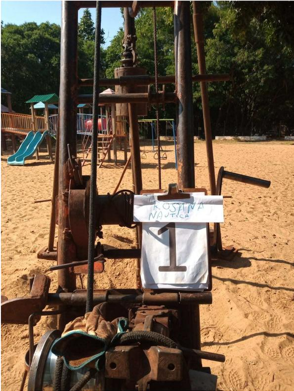
**Figura 1: Execução do furo de sondagem SP-01**
